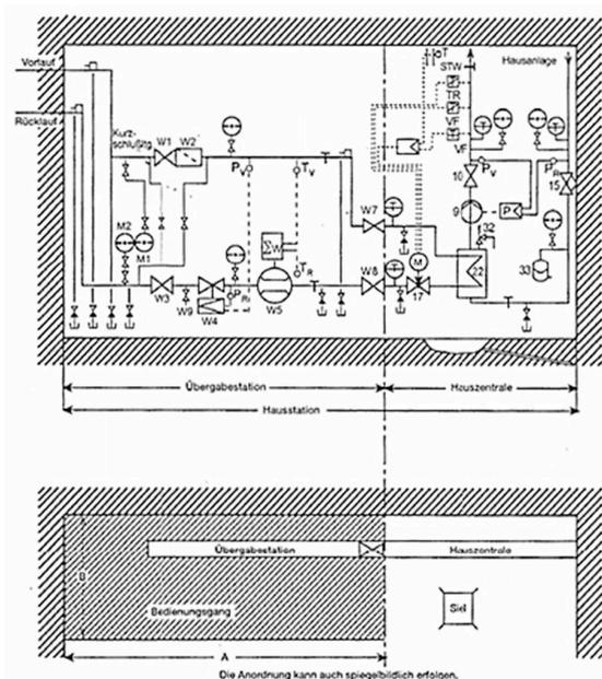
Abbildung 3: Platzbedarf Hausanschlussraum
